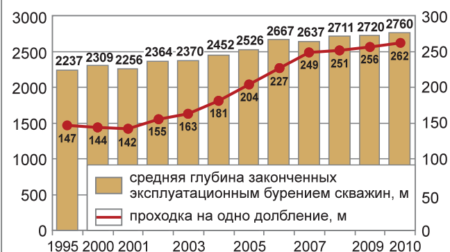
Рис. 7. Средняя глубина эксплуатационных нефтяных скважин и проходка на одно долбление в России в 1995–2010 гг.
