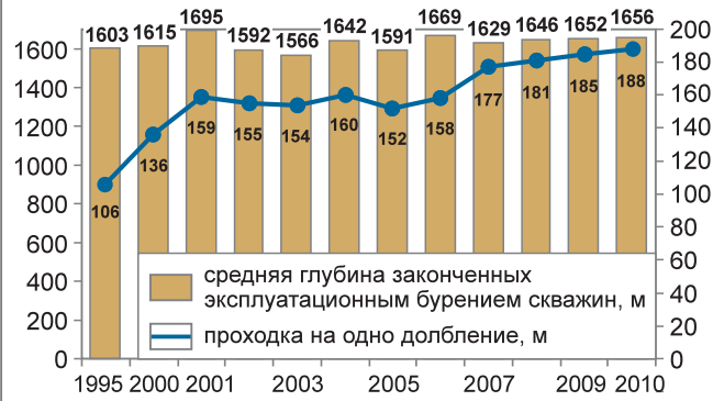
Рис. 11. Средняя глубина эксплуатационных газовых скважин и проходка на одно долбление в России в 1995–2010 гг.
