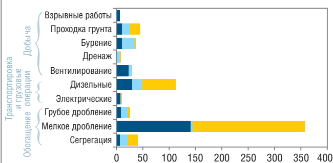
Рис. 2. Затраты энергии в горно-добывающей промышленности США для 10 наиболее энергозатратных процессов, трлн BTU*/год
