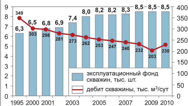
Рис. 8. Эксплуатационный фонд и дебит газовых скважин в России в 1995–2010 гг.
