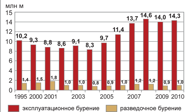
Рис. 6. Глубокое эксплуатационное и разведочное бурение на нефть в России в 1995–2010 гг.
