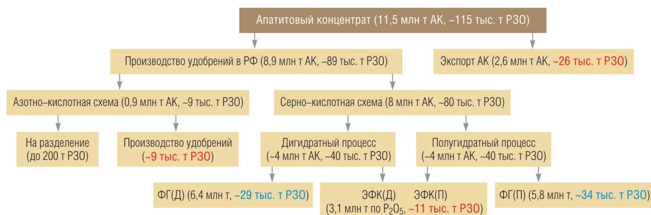
Рис. 4. Схема материальных потоков при производстве удобрений на основе апатитового концентрата
