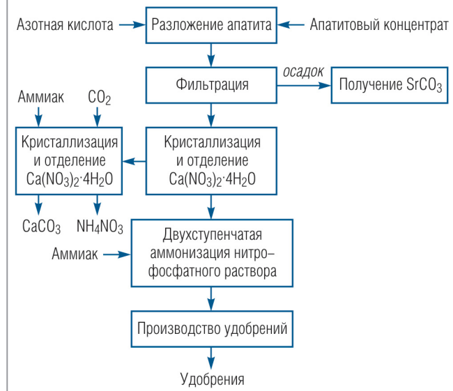
Рис. 1. Принципиальная схема переработки апатитового концентрата азотно-кислотным способом
