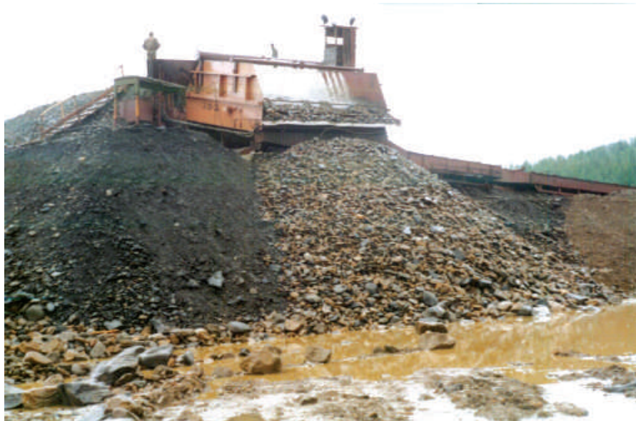
Прибор ГГМ-5 обеспечивает на валунистых песках производительность промывки 100 м 3 /ч
