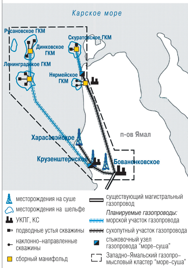
Рис. 2. Концептуальная кластерная схема системы раннего ввода в разработку залежей "сухого" газа ГКМ Ямала и приамальского шельфа Карского моря ("суша-море")
